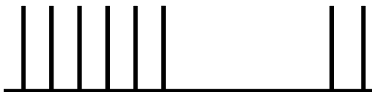
图 6 断续波输出波形
